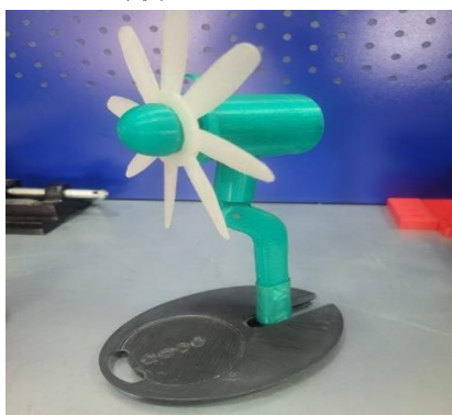
Рисунок 1. Рабочая модель вентилятора, изготовленная в условиях мастерской аддитивных технологий
